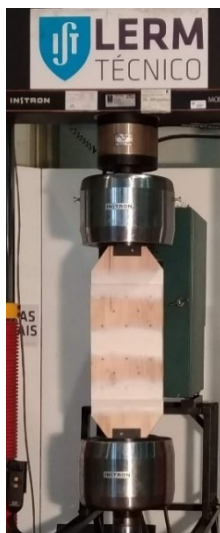
Figura 3.1 – Colocação dos provetes no equipamento INSTRON® e distância máxima entre garras
