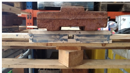
Figura 3.6 – Provede montado com massa de 25 kg durante a cura da cola
