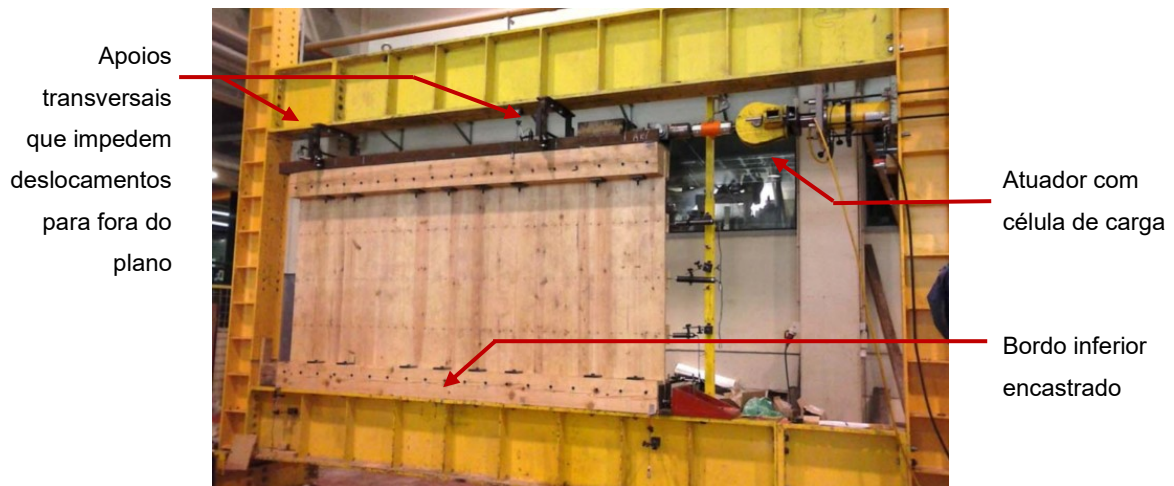
Figura 4.6 – Esquema de ensaio ao pavimento original desenvolvido em laboratório por Fragomeli (2015)
