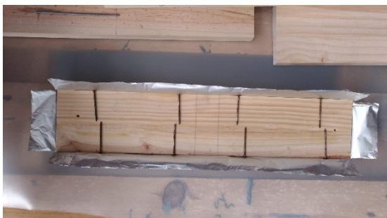
Figura 3.5 – Uso de pregos de 2 mm como espaçadores e aplicação da fita prata no contorno
